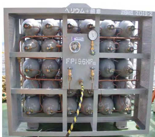
ヘリウム酸素混合ガス
